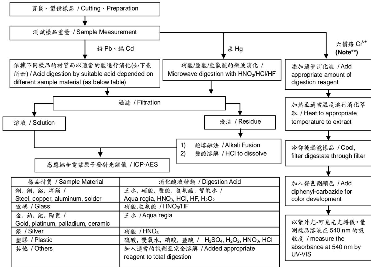
**Note\*\*:** (1) 針對非金屬材料加入鹼性消化液, 加熱至 90~95°C 萃取。 / For non-metallic material, add alkaline digestion reagent and heat to 90~95°C.
