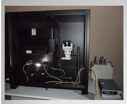
太陽光模擬器適用於單晶矽、多晶矽、非晶薄膜、染料敏化、有機、III-V族半導體等各種不同類型的太陽能電池。
